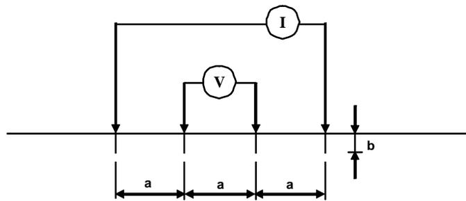
Figura 13. Esquema de medición de resistividad aparente.
