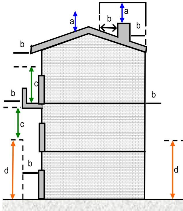
Figura 5. Distancias de seguridad en zonas con construcciones
